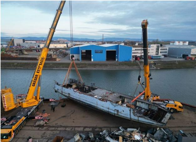
Lediglich die beiden Schrauben, der Anker und wenige maritime Gegenstände konnten vor den Stahlscheren gerettet werden. Das Gesamtgewicht der Zander betrug zum Zeitpunkt der Verschrottung 203,14 Tonnen, abzüglich 36,90 Tonnen Fremdanhaftungen und Flüssigkeiten, daraus ergab sich ein reines Stahlgewicht von 166,24 Tonnen.
