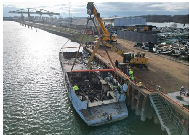
Eine Verbringung zu einem Abwrackbetrieb z.B. in den Niederlanden, wäre nur mit erheblichen Kosten verbunden gewesen. Die Abwrackarbeiten begannen Anfang Januar 2024. Mit zwei Mobilkränen wurde Mitte Januar 2024 der entkernte Rumpf der Zander aus dem Wasser gehoben und konnte an Land anschließend vollständig zerschnitten werden.
